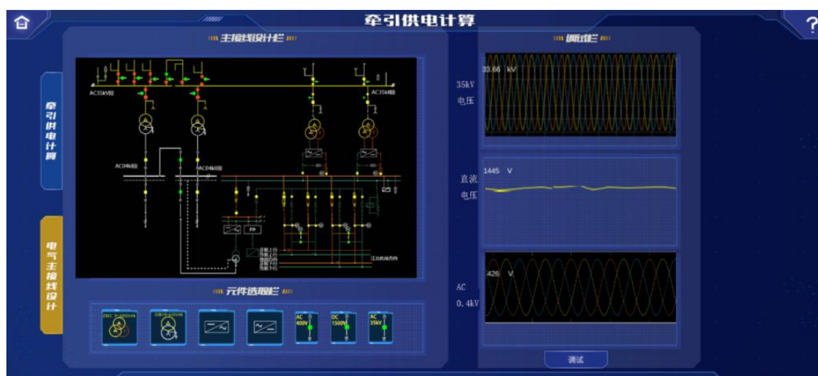
图 3-6-24 电气主接线仿真调试
