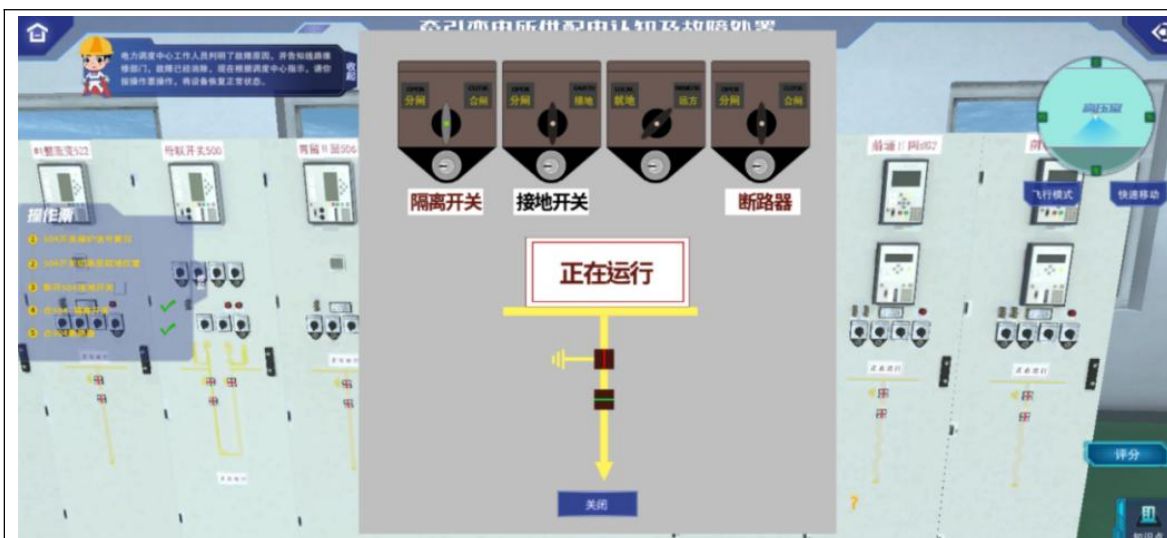
图 3-6-19 高压柜倒闸操作
